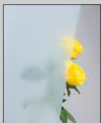
Стекло, подвергнутое пескоструйной обработке (Thermo65, Thermo46)
